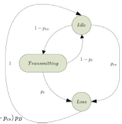
$$\mathbf{P} = \begin{bmatrix} 0 & 1 - p_{cs} & p_{cs} \\ 1 - p_{i}(T_{D}) & 0 & p_{i}(T_{D}) \\ 1 & 0 & 0 \end{bmatrix}$$
