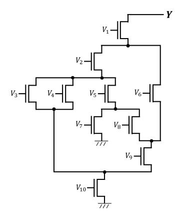
V<sub>1</sub>: 6X V<sub>2</sub>: 6X V<sub>3</sub>: 2X V<sub>4</sub>: 2X V<sub>5</sub>: 6X V<sub>6</sub>: 2X V<sub>6</sub>: 2X V<sub>7</sub>: 2X V<sub>8</sub>: 6X
