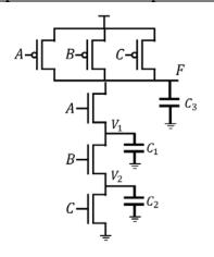
$\tau = R_{n,A}C_3 + R_{n,B}(C_1 + C_3) + R_{n,C}(C_1 + C_2 + C_3)$
