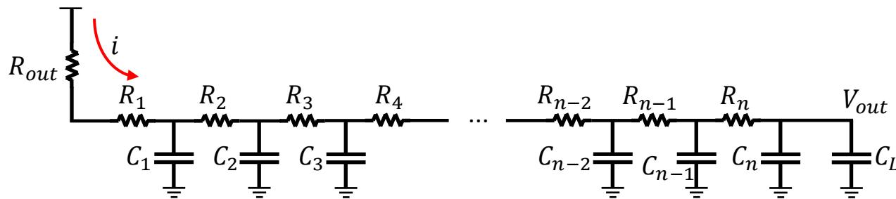
$$\begin{aligned}\tau = & R_n(C_n + C_L) + R_{n-1}(C_{n-1} + C_n + C_L) + R_{n-2}(C_{n-2} + C_{n-1} + C_n + C_L) + \\ & \dots + R_3(C_3 + \dots + C_n + C_L) + R_2(C_2 + \dots + C_n + C_L) + R_1(C_1 + \dots + C_n + C_L) + \\ & R_{out}(C_1 + \dots + C_n + C_L)\end{aligned}$$
