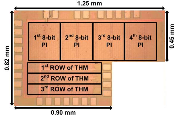
Fig. 11. Die micrograph in the 65-nm CMOS.
